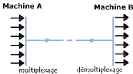
Ces opérations sont réalisées grâce au concept de ports (ou sockets), c'est-à-dire un numéro associé à un type d'application, qui, combiné à une adresse IP, permet de déterminer de façon unique une application qui tourne sur une machine donnée.
