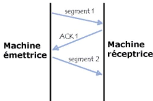
De plus, grâce à une minuterie déclenchée dès réception d'un segment au niveau de la machine émettrice, le segment est réexpédié dès que le temps imparti est écoulé, car dans ce cas la machine émettrice considère que le segment est perdu...
