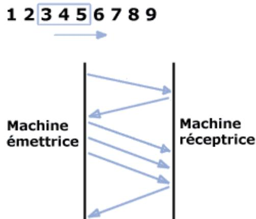
De plus, la taille de cette fenêtre n'est pas fixe. En effet, le serveur peut inclure dans ses accusés de réception en stockant dans le champ fenêtre la taille de la fenêtre qui lui semble la plus adaptée. Ainsi, lorsque l'accusé de réception indique une demande d'augmentation de la fenêtre, le client va déplacer le bord droit de la fenêtre.
