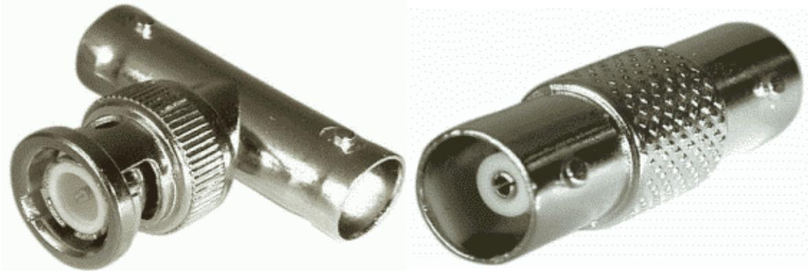
BNC est l'abréviation de Bayonet Neil-Concelman. Si Neil et Concelman sont les noms des deux créateurs de ce connecteur, le terme bayonet (baïonnette) est en référence au système d'attache d'une baïonnette sur un fusil. Au centre du connecteur on voit une broche reliée au fil de transmission des données. Le pourtour du connecteur mâle possède un anneau qui sert de système de fixation (à la manière d'une baïonnette donc).
